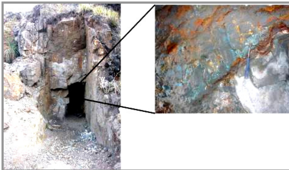
Foto N° 15.- En la foto de la izquierda se muestra el túnel de la Mina Santo Toribio, y foto derecha se aprecia la mineralización (óxidos y sulfatos de Cu)
