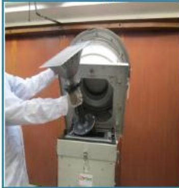
Ubicación del venturi dentro del cuerpo.
