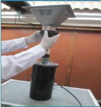
acoplamiento del venturi.
