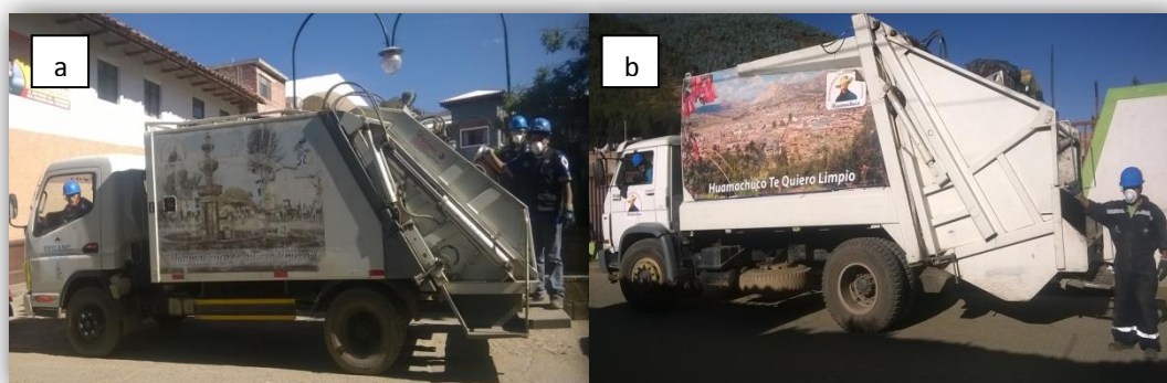
Figura 24. Compactadores utilizados en la recolección de residuos sólidos. (a) 5 Ton. (b) 12 Ton.
