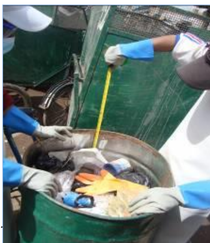
Imagen N° 9: Proceso para hallar la densidad de los residuos sólidos (Fuente: ECRS Distrito Puno, Mayo 2010)
