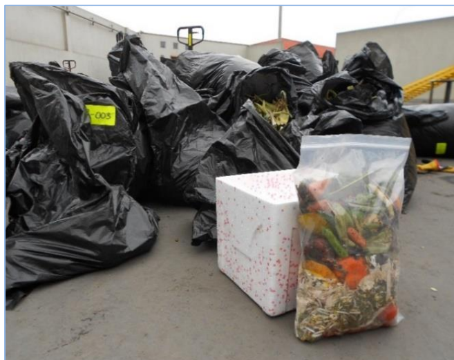
Imagen N°10: Recolección de muestra para determinar la humedad (Fuente: IPES)
