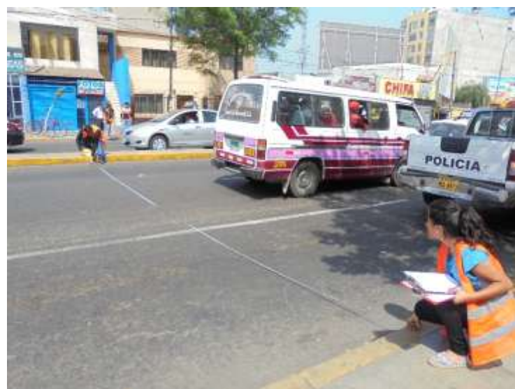
Foto 9. Medición de ancho de vía y número de carriles
