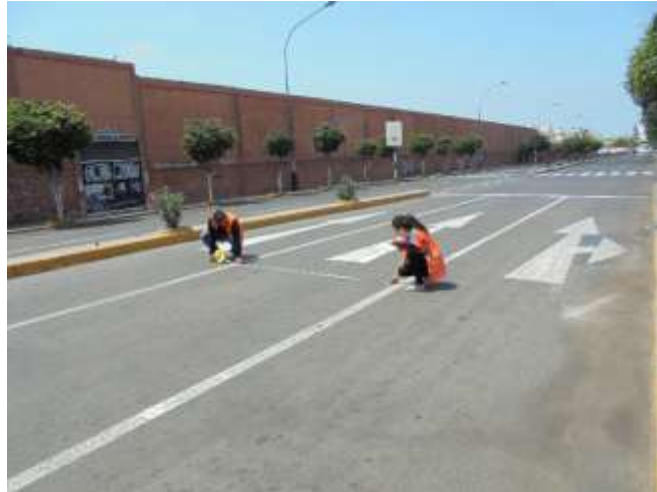
Foto 10 Medición de ancho de carril
