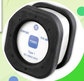
**Calibrador acústico de campo o Pistófono tipo I (Modelo: SV30A)**
