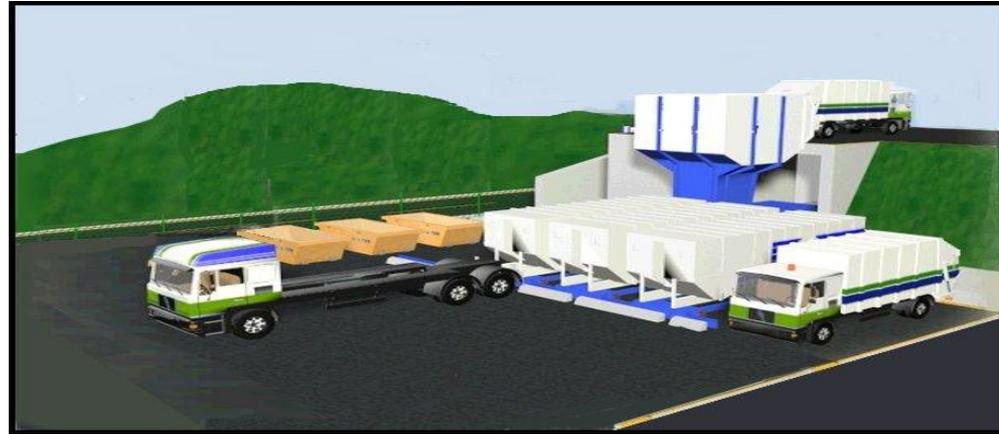
**Infraestructura de disposición final.-** Infraestructura destinada a la disposición final del residuo; comprenden los **rellenos sanitarios**, de **seguridad**, u otra infraestructura similar (escombreras).
