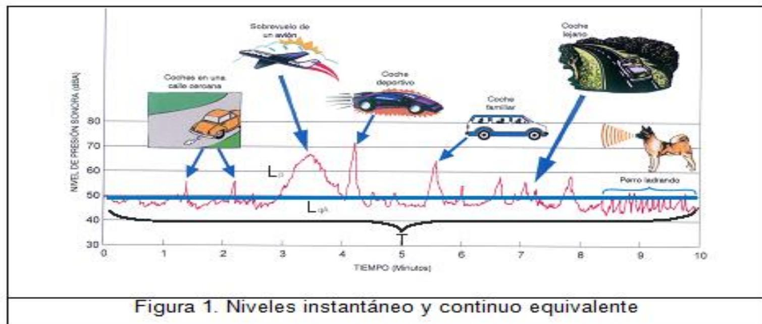
Figura 1. Niveles instantáneo y continuo equivalente
