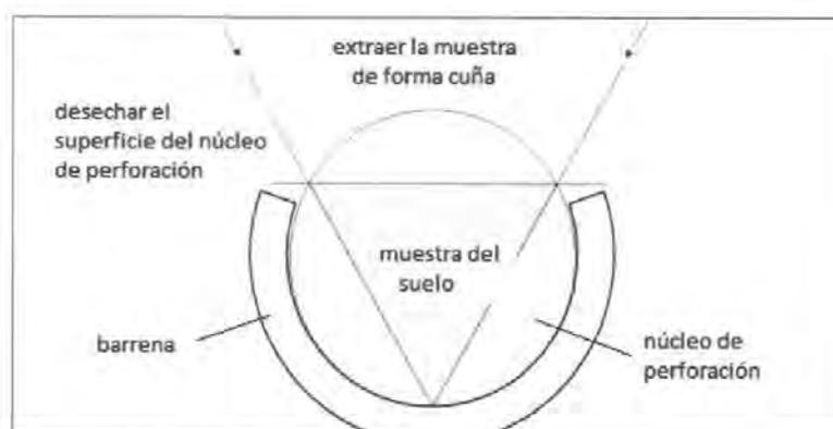
Ilustración 5: Croquis de la toma de muestra de un núcleo de perforación
