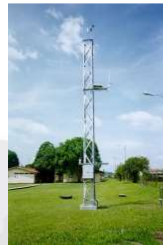
ESTACION METEOROLOGICA AUTOMATICA
