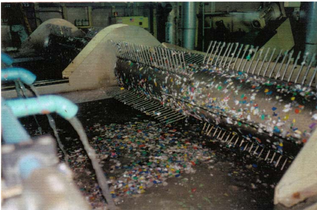
Fotografía 8: Trituración de los plásticos en trozos finos (Planta recicladora de plástico, Turquía)
