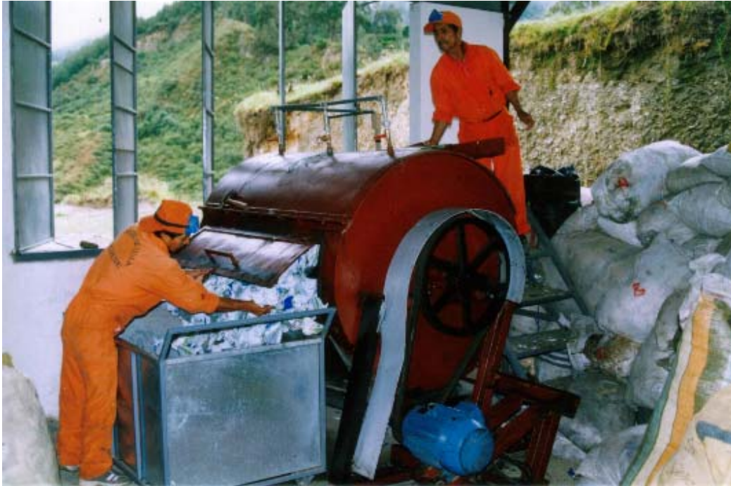
Fotografía 8: Trituración de los plásticos en trozos finos (Planta recicladora de plástico, Turquía)
