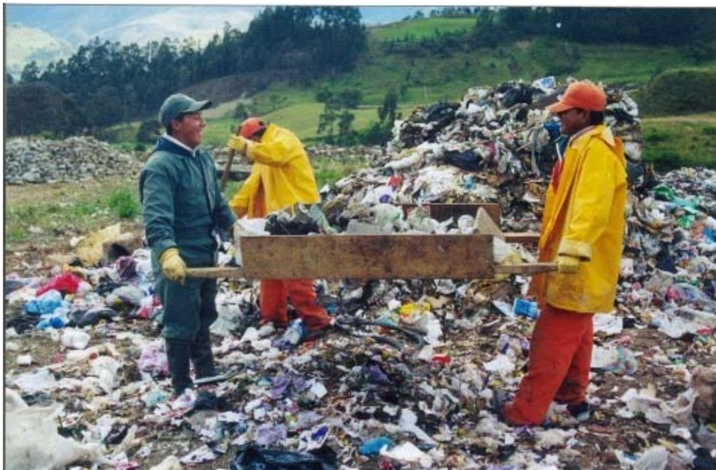
Fotografía 1: Análisis del tamaño de las partículas mediante un tamiz manual
