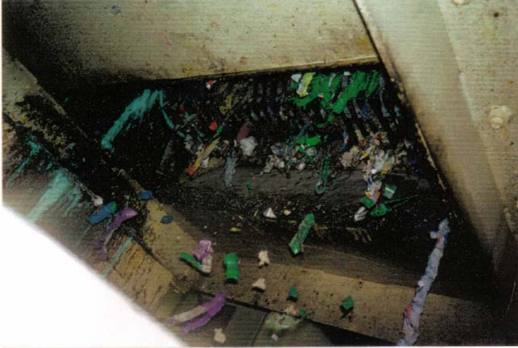
Fotografía 9: Lavado de los plásticos, separación del material lavado (Planta recicladora de plástico, Turquía)
