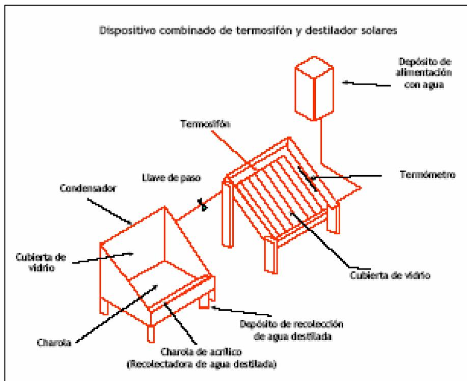
El termosifón es un gabinete de madera sellado y cubierto con dos vidrios transparentes de 79 x 77 cm separados 2 cm entre sí. El colector está formado por 17 tubos de cobre de 1,5 cm de diámetro que se conectan a dos cabezales de 2,5 cm de diámetro uno inferior de abastecimiento y otro superior de salida. La estructura se apoya en una charola de lámina y todo está pintado en negro mate.
