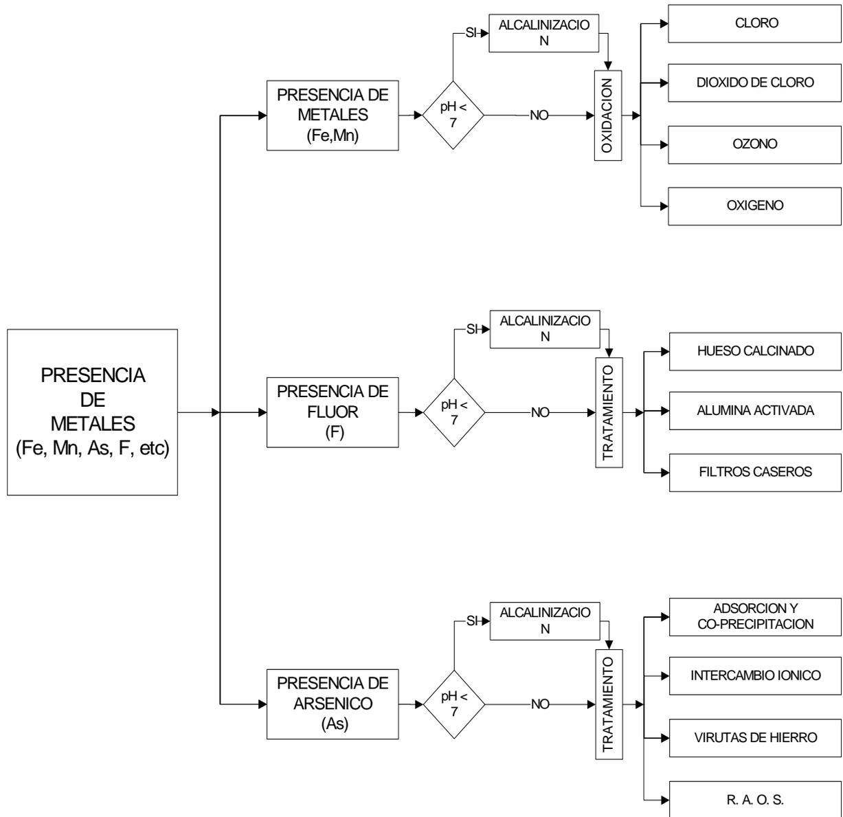
En los diversos métodos que se verán en la remoción de metales, uno de los requisitos importantes para la realización de los tratamientos es el acondicionamiento del agua a un pH determinado (generalmente  $\text{pH} > 7$ ), es por ello que se tendrá en cuenta el proceso de alcalinización.
