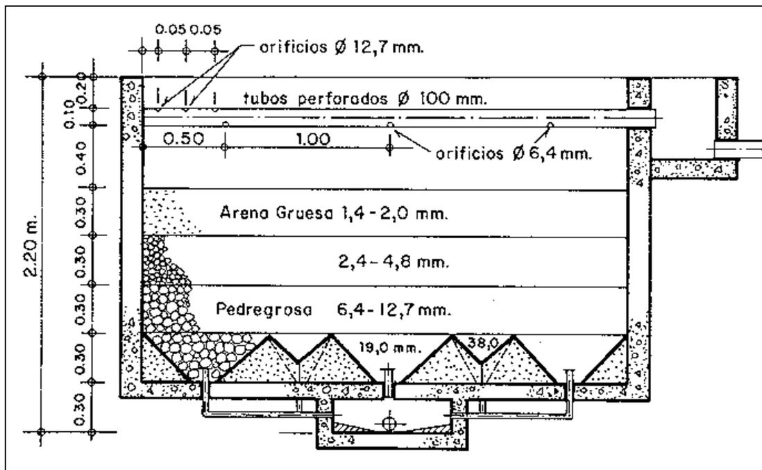
El sistema de recolección de agua tratada está conformado por tuberías de f 4" con orificios de f 12,7 mm a 0,05 m, centro a centro, que conducen el efluente a una caja de recolección. Este sistema se ubica a 0,40 m sobre la superficie del medio filtrante.
