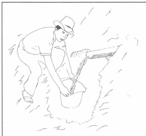
Figura 3.6 : Aforo del agua por el método volumétrico
