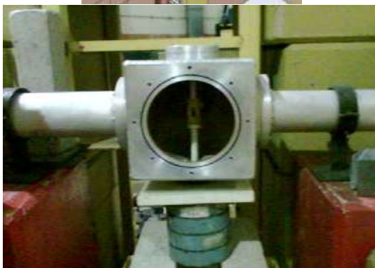
Figura 4: Arriba, esquema general de la instalación de facilidad, abajo fotografía de portamuestra de aluminio, con soporte de muestra y blindaje primario del detector de GeHP.
