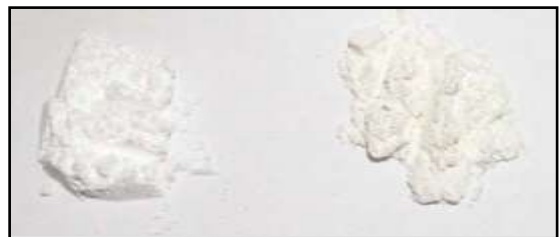
Figura 2: Diferencia de color entre muestras de Acetato de Medroxyprogesterona irradiadas a 0 (izquierda) y 40 kGy (derecha).
