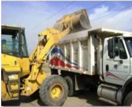
Fotografía 13. Volquete de 15 m<sup>3</sup> y Cargador Frontal
