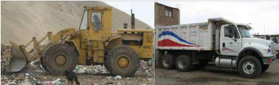
Fotografía 25. Cargador frontal y camión volquete utilizados en la disposición final.
