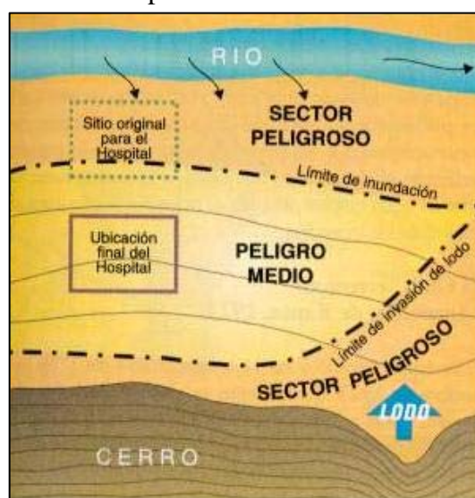
Fig. 1.7 Ubicación Original y Final de un hospital en la selva central -
