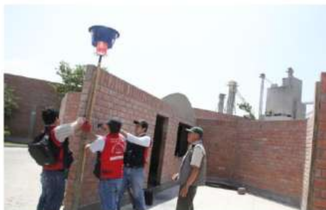
Figura 151: Instalación de Muestreadores de Polvos Sedimentables para comprobar si la emisión de polvos generados superan el Estandar de Calidad de Polvos Sedimentables
