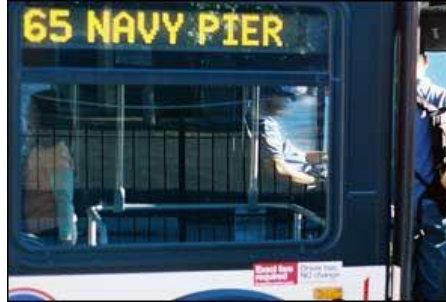
Foto 5 - Señalización de destino exterior
