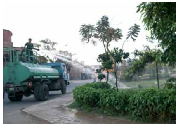
Figura N° 2.51: Riego de áreas verdes con aguas residuales tratadas y desinfectadas.
