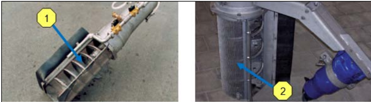
Imagen 59: Tamiz de tornillo Ro9. En la parte izquierda se encuentra un tornillo transportador desarmado (1). En la parte superior derecha se observa el tamiz giratorio (2).
