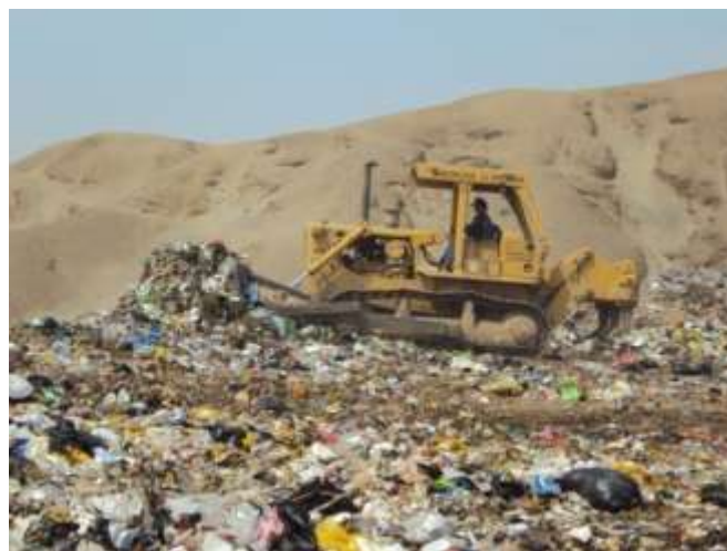
Foto 01 y 02.- Tractor oruga de la Municipalidad de la Esperanza esparciendo y compactando la basura en el Botadero el Milagro.
