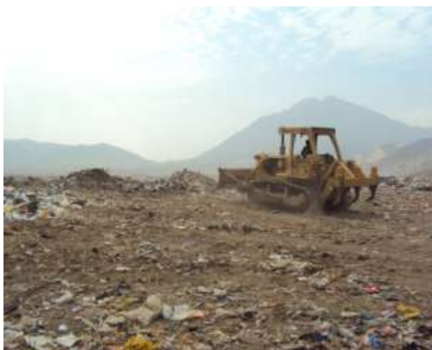
Foto 01 y 02.- Tractor oruga de la Municipalidad de la Esperanza esparciendo y compactando la basura en el Botadero el Milagro.
