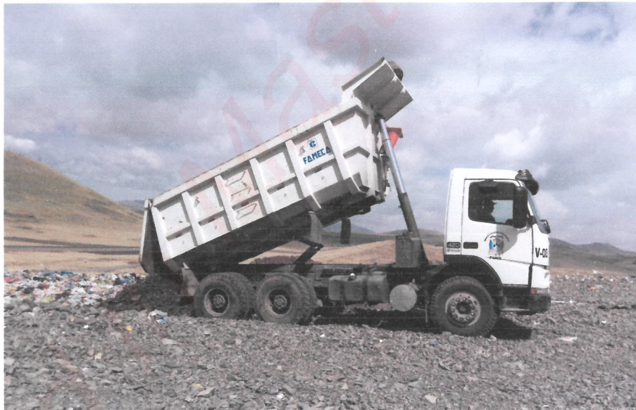
Fotografía N° 7. Volquetes para el transporte de material de cobertura.
