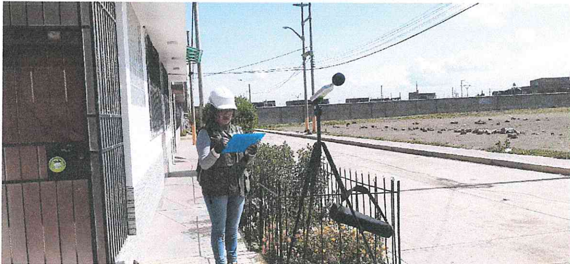
Fotografía 5.- Medición de Ruido Ambiental de fuentes fijas en la Av. Los Olivos, del C.P Salcedo, (28 de enero del 2020).
