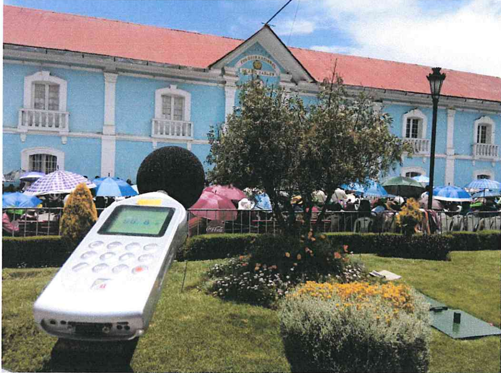
Fotografía 3.- Medición de ruido ambiental, punto de medición Parque El Pino (02 de febrero del 2020).
