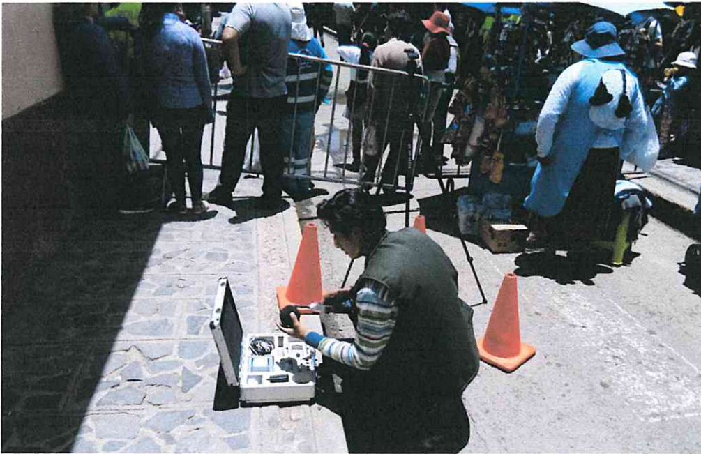
Fotografía 1.- Instalación de equipos de medición de ruido ambiental, punto de medición Jr. Libertad, intersección con Jr. Arequipa (02 de febrero del 2020).
