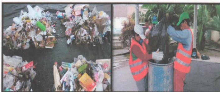
Foto N°14: Método de cuarteo para el cálculo de la densidad
