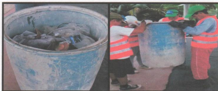
Foto N°14: Método de cuarteo para el cálculo de la densidad
