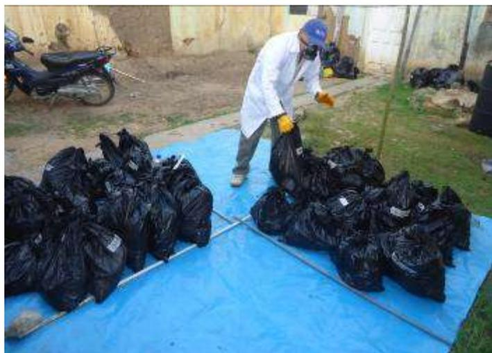
Para determinar la densidad suelta de los residuos sólidos se acondiciono un cilindro metálico de 0.20 m<sup>3</sup> de capacidad, Se colocaron las muestras debidamente pesadas buscando llenar el cilindro, se registro el peso.
