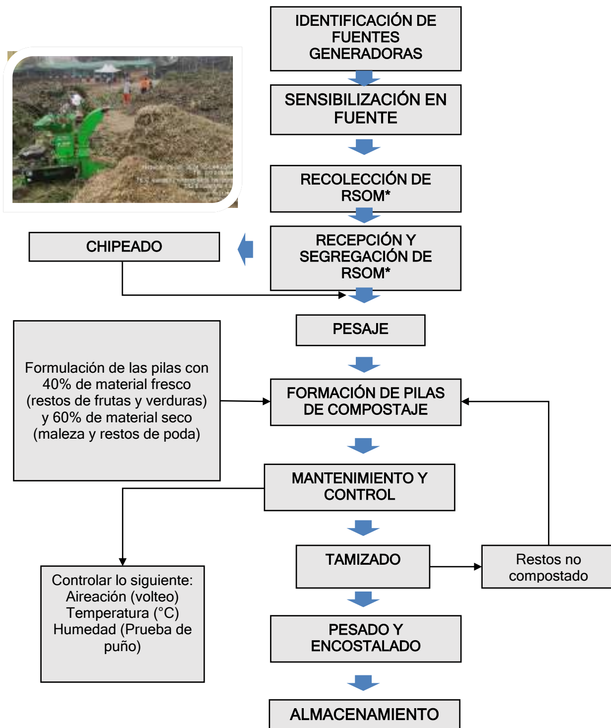
Ilustración N°06: Diagrama de flujo del proceso de compostaje de residuos orgánicos
