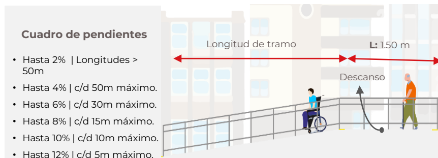
VISTA ELEVACIÓN LATERAL
