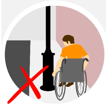
VEREDAS OBSTACULIZADA POR POSTES U OTROS ELEMENTOS
