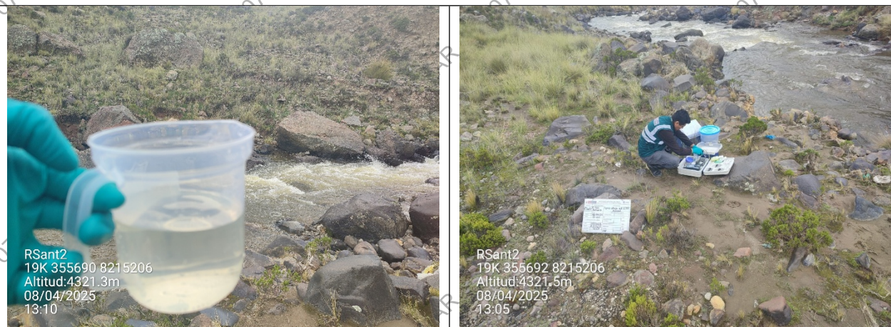
Foto N° 006 y 007: Muestra de agua superficial del punto RSant2 ligeramente turbia, con presencia de sólidos finos suspendidos. A la derecha se observa al especialista de campo realizando la medición de los parámetros de campo.
