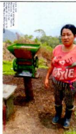
Despulpadora en la interperie instalado en un tronco cerca a una fuente de agua.
