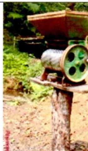
Despulpadora en la interperie instalado en un tronco cerca a una fuente de agua.
