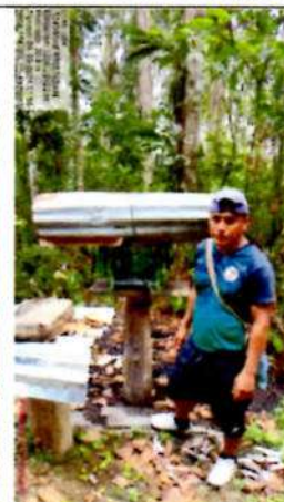
Despulpadora en la interperie instalado en un tronco cerca a una fuente de agua.
