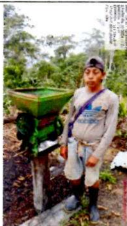
Despulpadora en la interperie instalado en un tronco cerca a una fuente de agua.
