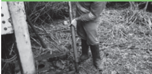
A.2. Insertar el barrilete con el liner
