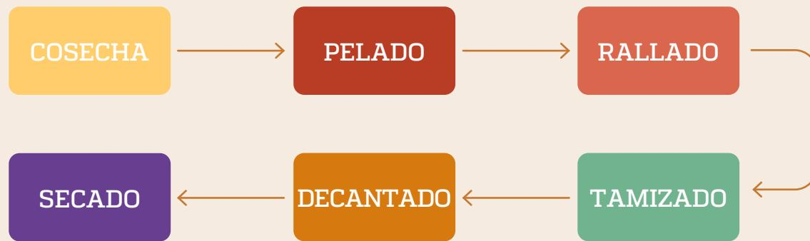
Figura 62. Fases del proceso de preparación de almidón de yuca (IIAP, 2018)
