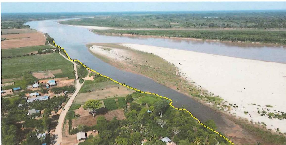
Tramo de erosión fluvial en la margen izquierda del río Pachitea, el camino vecinal y terrenos se encuentran expuesto al peligro.
