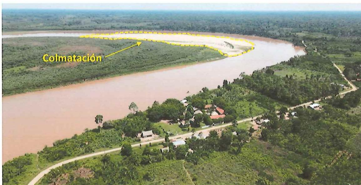
Colmatación en el lado derecho del cauce de río Pachitea, el cual lleva las aguas con mayor velocidad de erosión a la margen izquierda.
