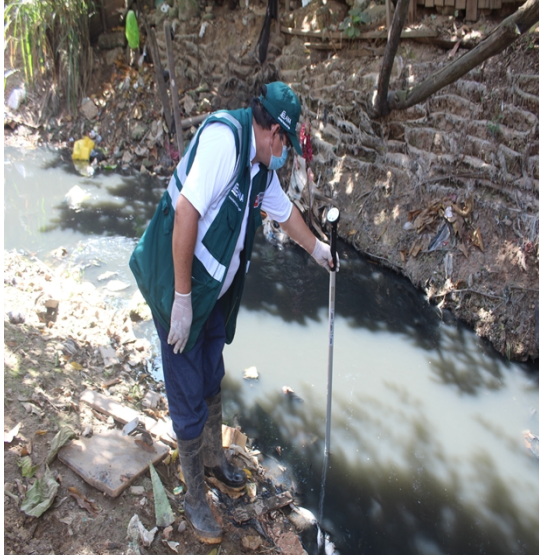
Medición de caudal de la quebrada Yumantay, con un correntómetro.
