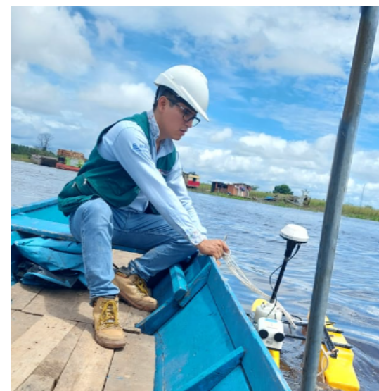
Medición de caudal de la quebrada Manantay, con un equipo ADCP.
