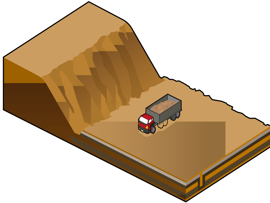
Ilustración N°20. Cobertura de tierra como protección en parte de la superficie base
