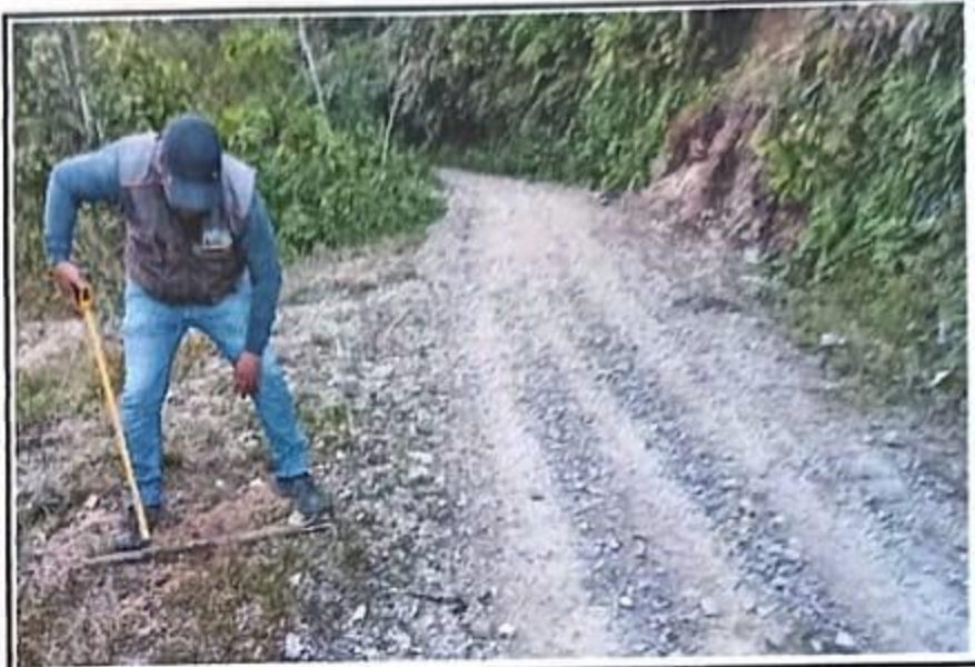
Foto 02. Se observa un espesor de pavimento de 0.13 cm. Progresiva 00+250, tiene bombeo.
