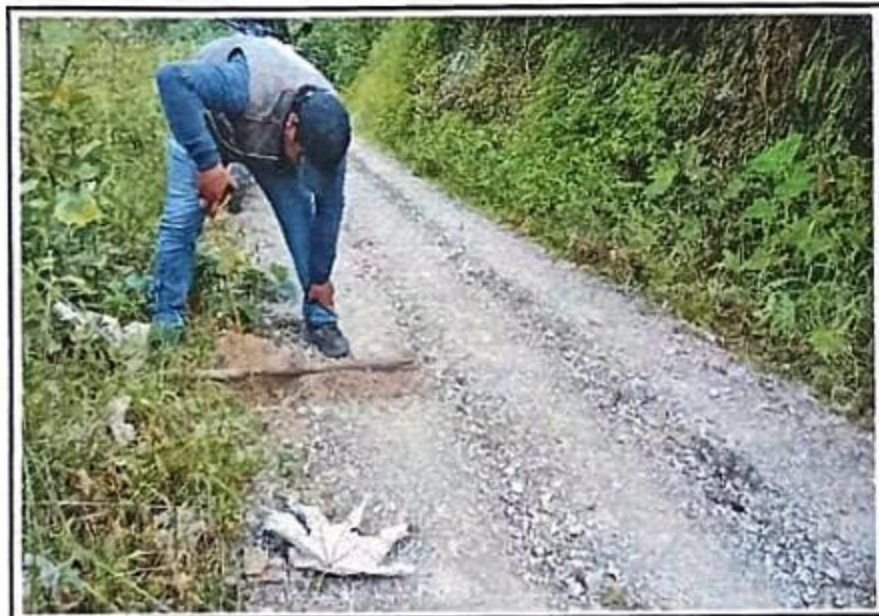
Foto 15. Se observa un espesor de pavimento de 0.16 cm. Progresiva 03+500, no tiene bombeo.
