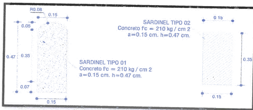
Imagen N°04: DETALLE DE SARDINEL SUMERGIDO TIPO 01
