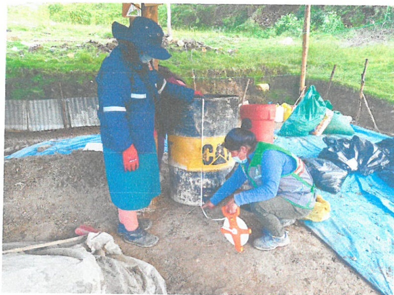
Ilustración 12. Determinación de la densidad de los residuos sólidos del distrito de La Union, medición de la altura de vacío.
