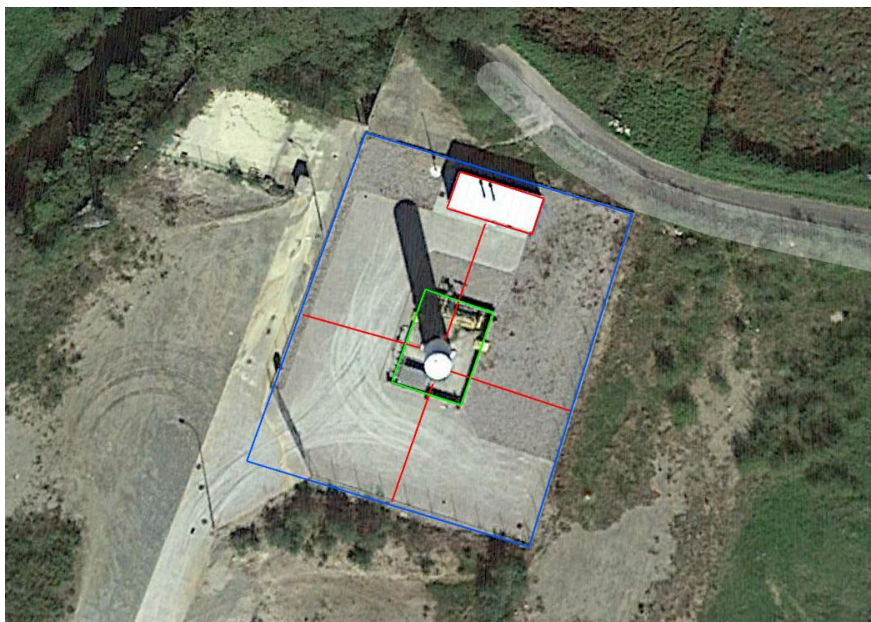
Imagen de referencia de implantación PSR de bajo almacenamiento con Distancias de Seguridad
