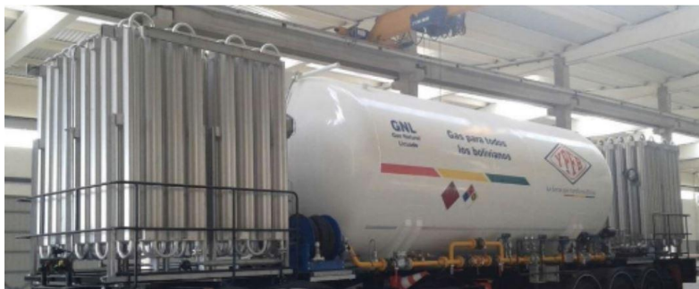
Imagen de Instalación de regasificación de GNL paquetizada 20 m3 x 400 Sm3/h
