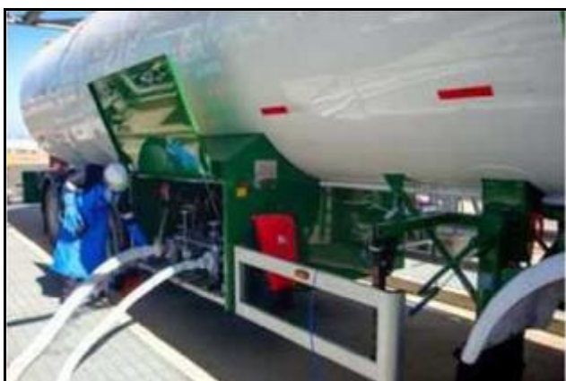
Fotografía 2: Proceso de llenado de gas licuado en los camiones cisterna
