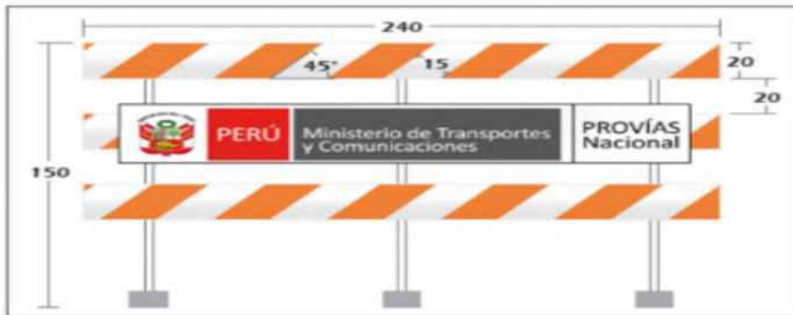
Figura 53. Barrera o tranquera con dimensiones en cm.
