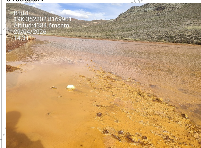
Fotografía N° 07. vista de la zona de muestreo del punto de monitoreo RTiti1, en este sector el nivel de pendiente es menor formando remansos y permitiendo la acumulación de un sólido fangoso (hidróxido férrico) en sus orillas
