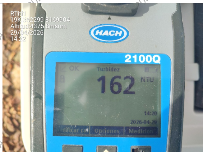
Fotografía N° 08. vista del resultado de la medición de la turbidez cuyo valor es 162 NTU lo que representa una alta presencia de sólidos suspendidos en agua.
