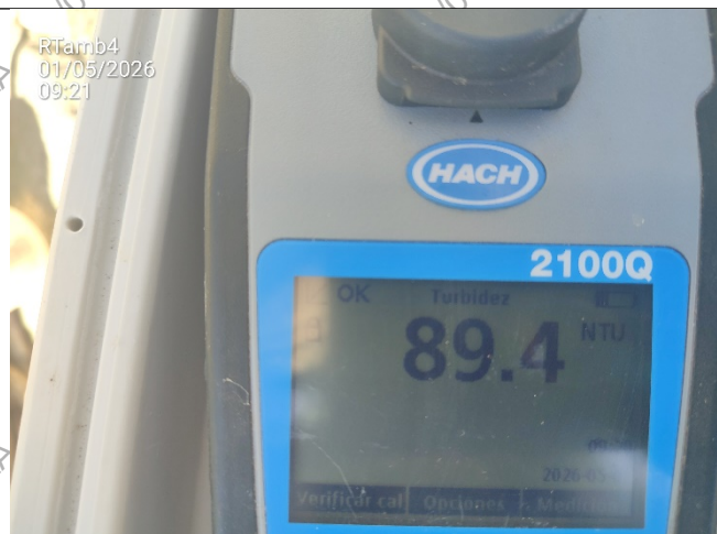
Fotografía N° 20. vista del resultado de la medición de la turbidez cuyo valor es 89.4 NTU.
