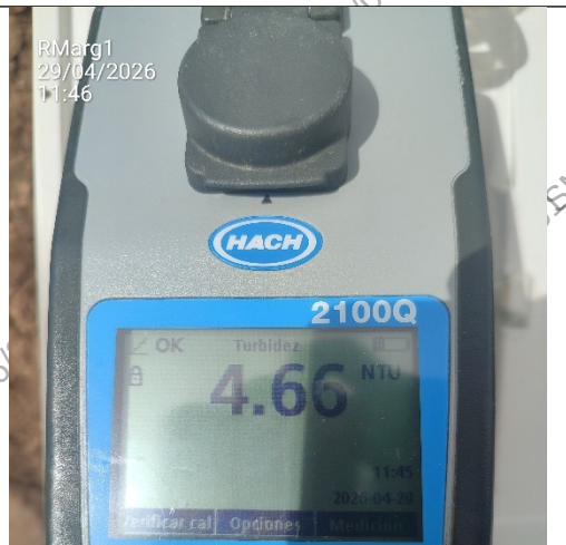
Fotografía N° 04. vista del resultado de la medición de la turbidez cuyo valor es de 4.66 NTU lo que representa una baja presencia de sólidos suspendidos en agua
