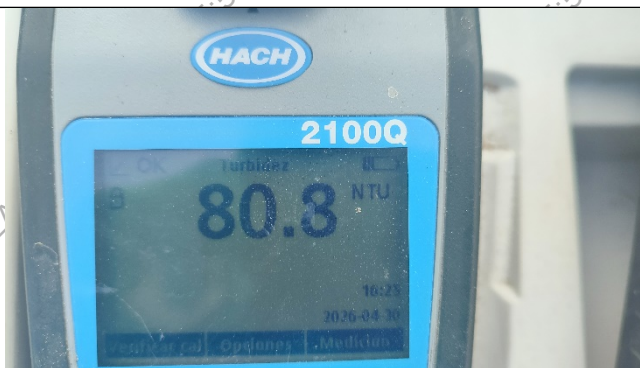
Fotografía N° 16. vista del resultado de la medición de la turbidez cuyo valor es 80.8 NTU.
