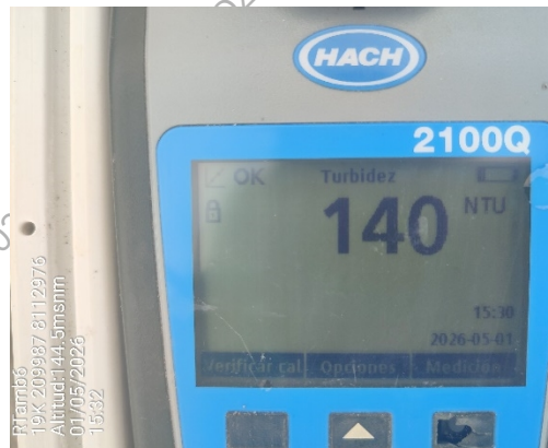
Fotografía N° 20. vista del resultado de la medición de la turbidez cuyo valor es 140 NTU.
