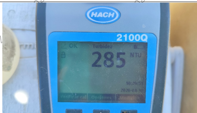
Fotografía N° 12. vista del resultado de la medición de la turbidez cuyo valor es 285 NTU, lo que representa una alta presencia de sólidos suspendidos en agua.
