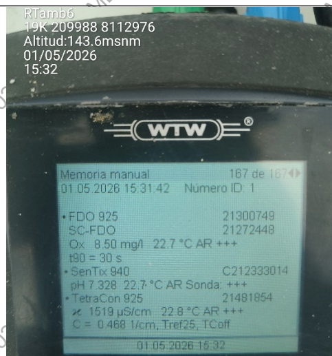
Fotografía N° 22. vista del resultado de los parámetros de campo, pH 7.33, CE: 1519 uS/cm. Temp: 22,8 °C. OD: 8.50 mg/L.
