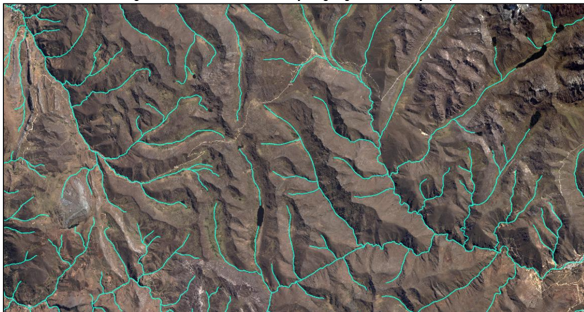
Figura 13: Vectorización del objeto geográfico Drenaje Superficial
